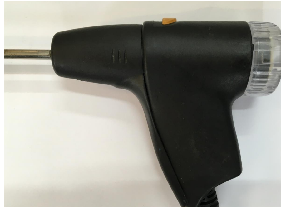
Her er røggastemperaturføleren skiftet og sonden er tæt igen.
