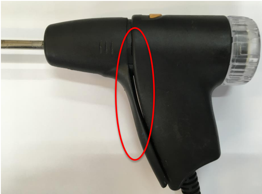
Røggassonde sluttede ikke tæt ved samling.
